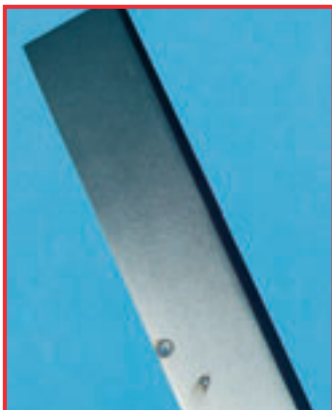
Korrosjonsangrep på meisel
