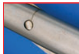
Hårfin sprekkdannelse (fraktur) på sakseledd
