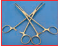
Kontaktkorrosjon mellom to rustfrie stål instrumenter
