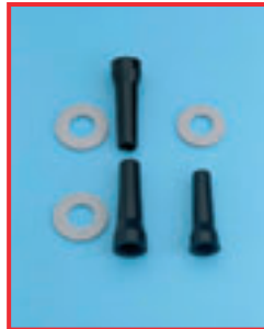
Oppsvulmete pakninger Årsak – uforsiktig påføring av instrumentolje
