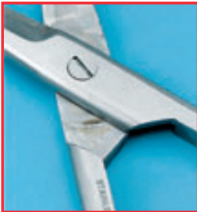
Friksjonskorrosjon Årsak: utilstrekkelig smøring
