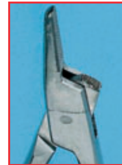
Kjeve brekkasje på nåleholder
