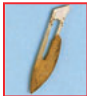
Rustdannelse på skalpellblad. Årsak: Ikke rustfritt stål - engangsutstyr
