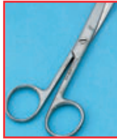
Saks med groppkorrosjon
