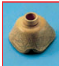
Sprekkdannelse respirasjons-maske - forårsaket av aldringsprosess
