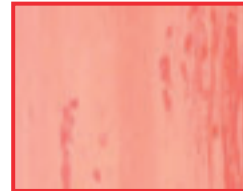
Skade på aluminium flate Årsak: Bruk av sterkt alkalisk middel
