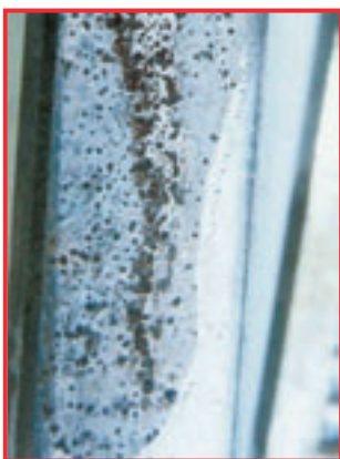
Avleiringer av et klorholdig "etsende" belegg på et instrument
