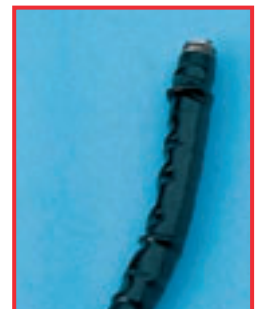
Oppsvulming på distal ende på fiberskop
