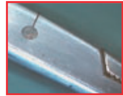
Sprekk i hengsel
