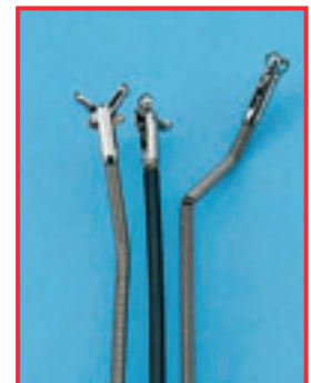
Biopsipinsetter skadet av mekaniske krefter
