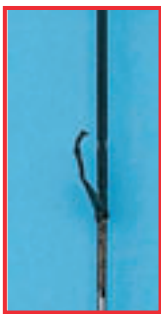
Skadet isolering på HF-instrument
