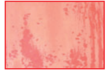
Synlige fargerforandringer skjer på eloksert aluminium selv i svakt alkaliske oppløsninger
