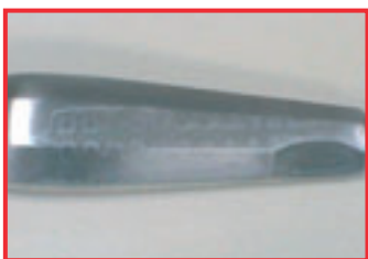
Overføring av rengjøringsmiddelrester på grunn av utilstrekkelig skylling
