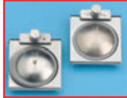
Trokarventil med lekkasje Årsak – oppsvulming av pakning etter kontakt med olje
