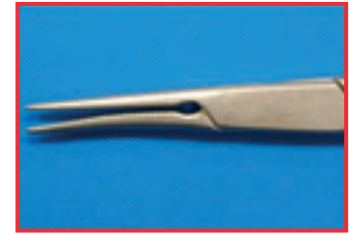
Skade som følge av uforsiktig håndtering
