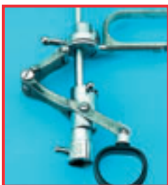
Skade på aluminium -skomponenter. Årsak: Bruk av sterkt alkalisk middel
