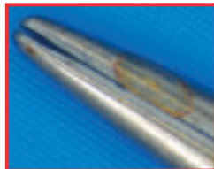
Syreangrep på sveising og hardmetall innsats. Følgelig -slitasjeskader Årsak: Overdosering
