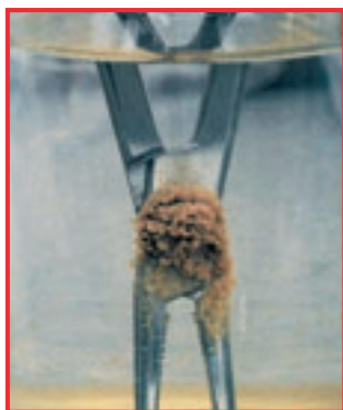
Korrosjon forårsaket av nedsenking i fysiologisk saltoppløsning i flere timer
