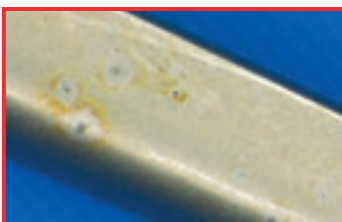
Gropkorrosjon på instrument forårsaket av klorider
