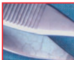
Misfarging med tydelige grenser
