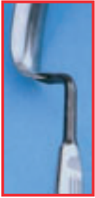
Instrument med kromium-nikkel stål og misfarget krom stål
